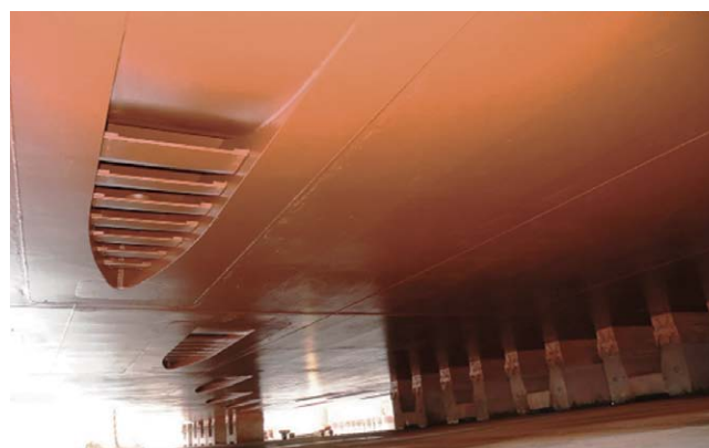
Рис. 7. Устройства выпуска воздуха на днище судна [17]
