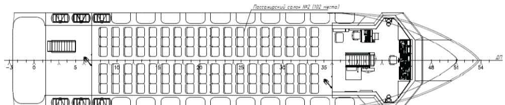
План при снятой главной палубе
